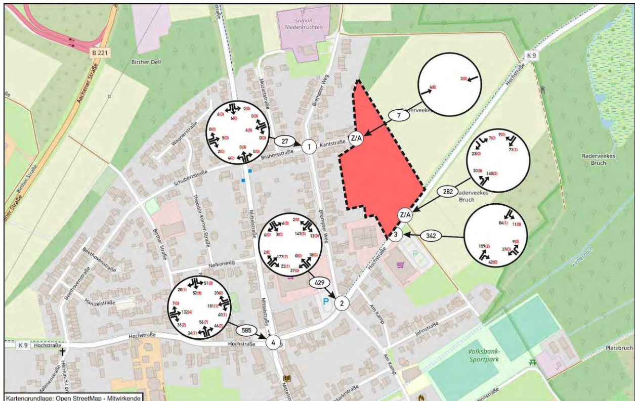
Abbildung 9: Verkehrsbelastungen im Prognose-Planfall zur morgendlichen Spitzenstunde [Kfz/h (SV/h)] (Kartengrundlage: Open StreetMap - Mitwirkende)
