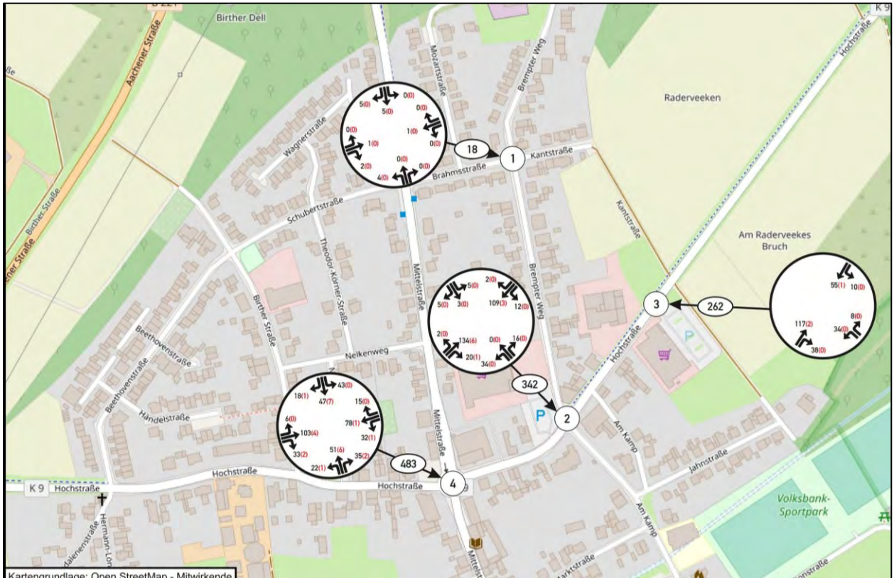
Abbildung 2: Verkehrsbelastungen der morgendlichen Spitzenstunde am Dienstag (07:30 - 08:30 Uhr) [Kfz/h (SV/h)] (Kartengrundlage: Open StreetMap - Mitwirkende)
